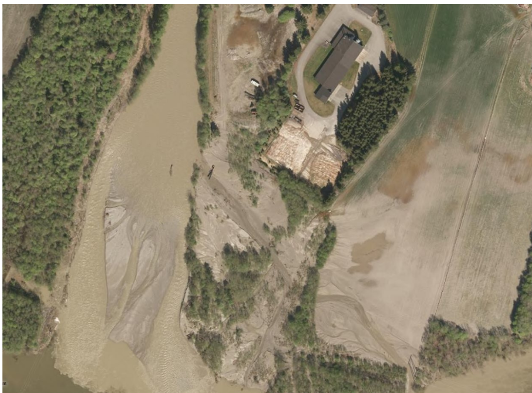
Figur 18. Bildet er tatt under flommen i 2013. Det er tydelig at Frya tar nye løp og gjør skade på dyrka marka i øst og tilfører arealet mye finstoff. Også slamdeponiet til renseanlegget sør for selve bygget er berørt.
