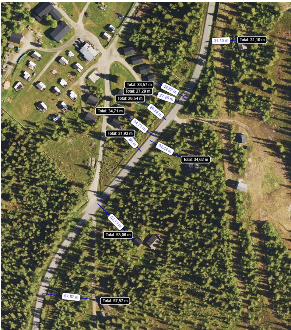
Illustrasjon 31: Viser dagens bebyggelse langs Fv27 med i lagt byggegrense på inntil 26 meter fra senterlinje vei.
